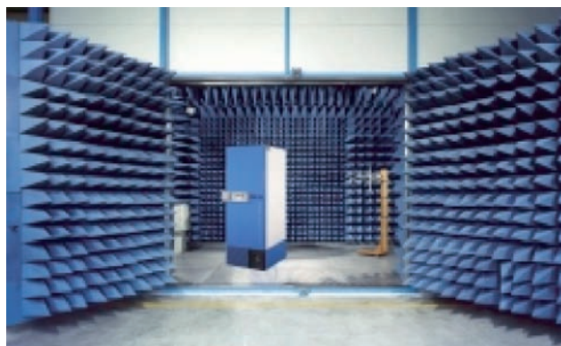
Nostra camera anecoica per prove di compatibilità elettromagnetica (marchio CE) Our anechoic chamber for EMC test (CE mark)
